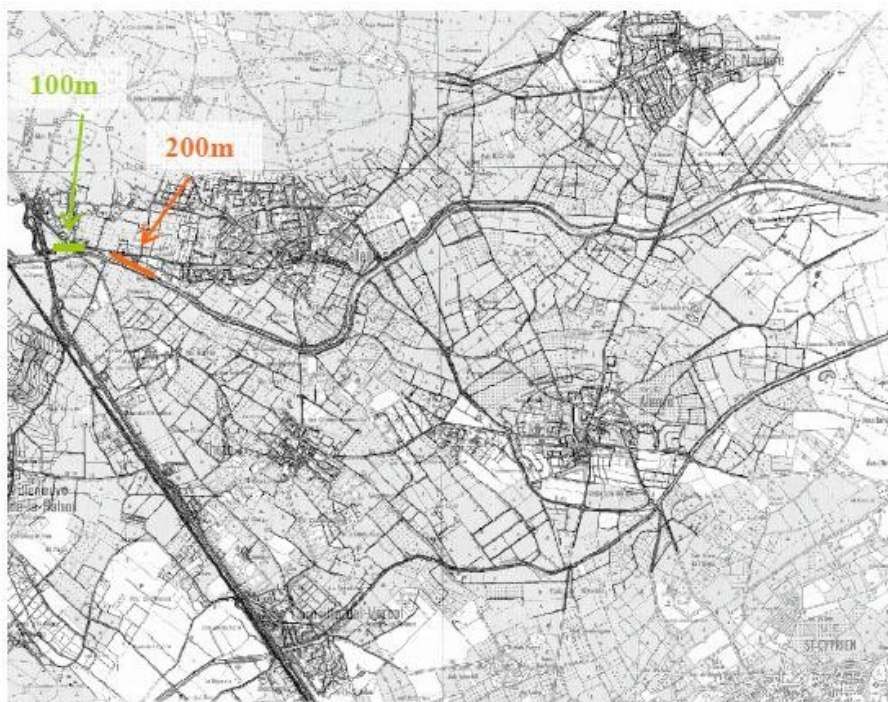
Localisation des brèches du scénario 1 : rupture en rive gauche en aval du pont, à l'amont immédiat de Salleiles
