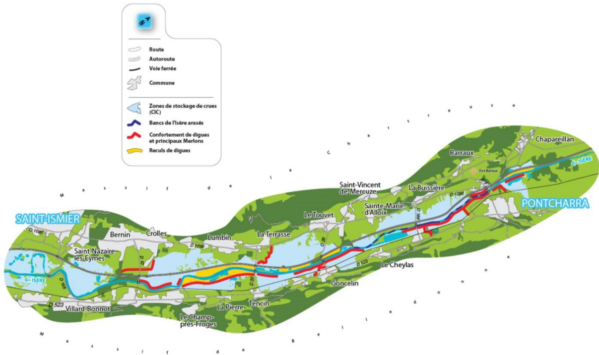
Figure 5: Localisation des travaux en cours de réalisation des tranches 2 et 3 du projet Isère Amont
