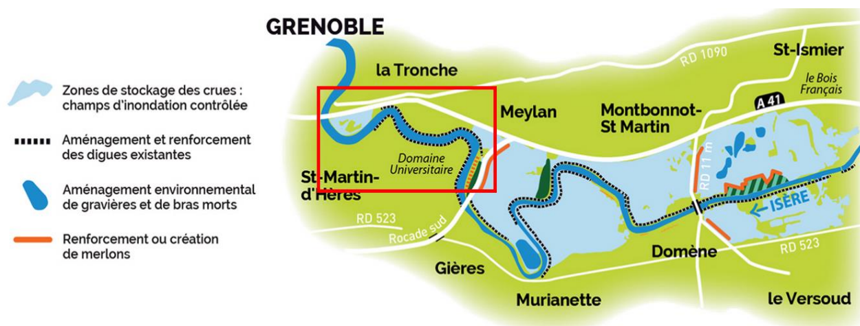
Figure 14 : Localisation du secteur d'étude (en rouge) dans le plan synoptique des travaux de la tranche I du projet Isère amont (crédit image : Bruno Fouquet)
