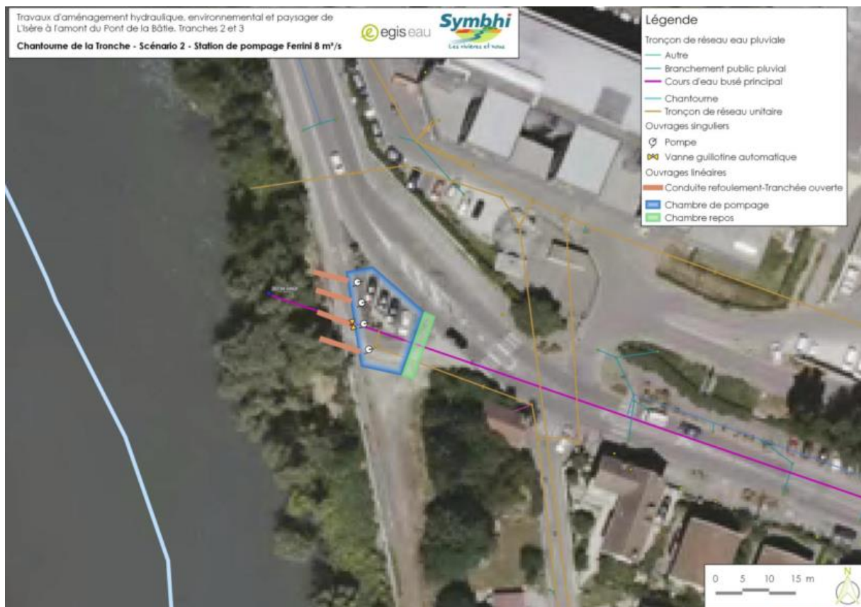
Figure 25 : Vue en plan des aménagements prévus à l'exutoire de la chantourne dans le scénario n°1
