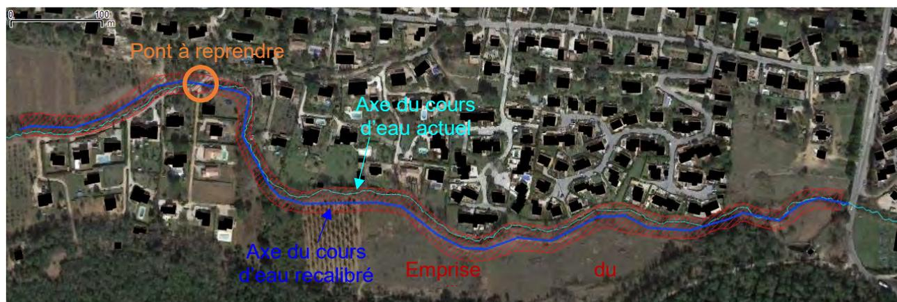
**Figure 19 : Emprise du recalibrage du cours d'eau**
