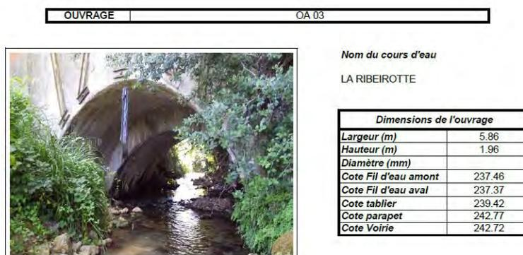
Figure 4 : Relevé de l'ouvrage de la RD554
