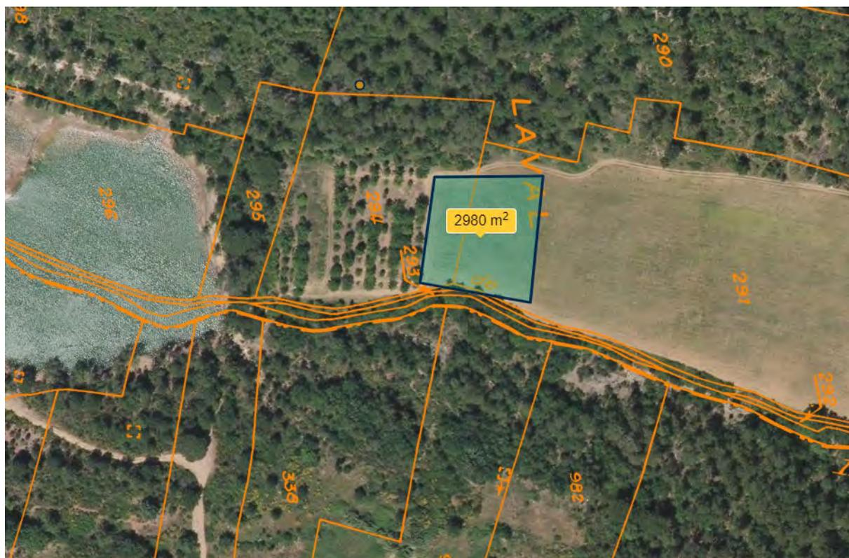
Figure 10 : Surface potentiellement nécessaire pour un emprunt d'environ 4000 m<sup>3</sup> de matériaux
