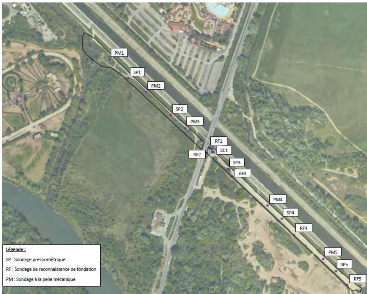
Figure 7: Sondages géotechniques réalisés
