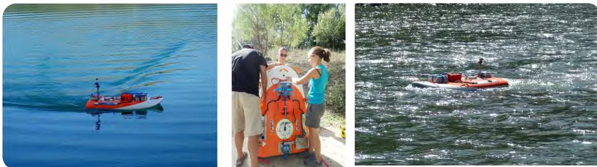
Figure 13 : ADCP acquis par la DREAL (action 14) en cours d'utilisation à Roquebrune-sur-Argens.
