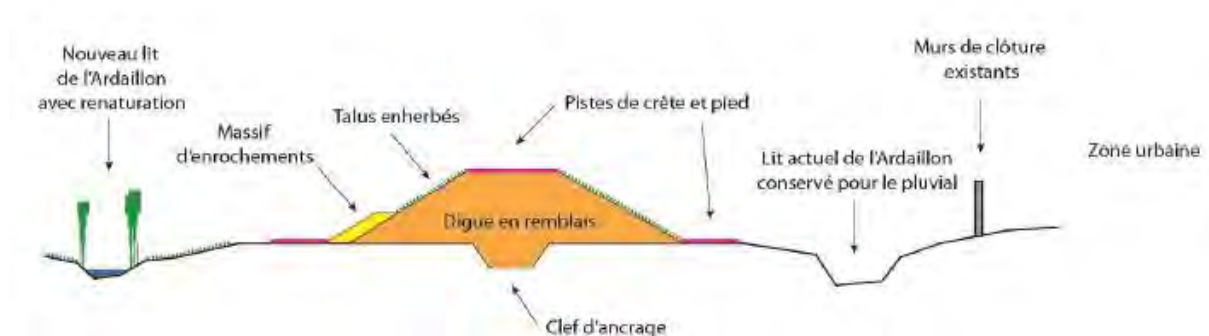
FIGURE 6 : PROFIL TYPE DE LA DIGUE DE BESSAN
