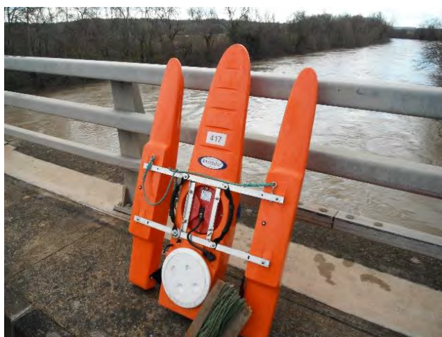
Sondeur DREAL au pont de Paulhan en 2013 – photo EPTB FH
