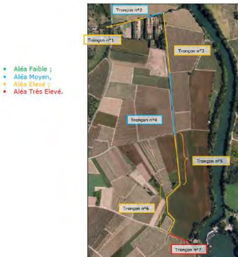
FIGURE 7 : RISQUE DE RUPTURE DE LA DIGUE ELOIGNEE EXISTANTE DE BESSAN
