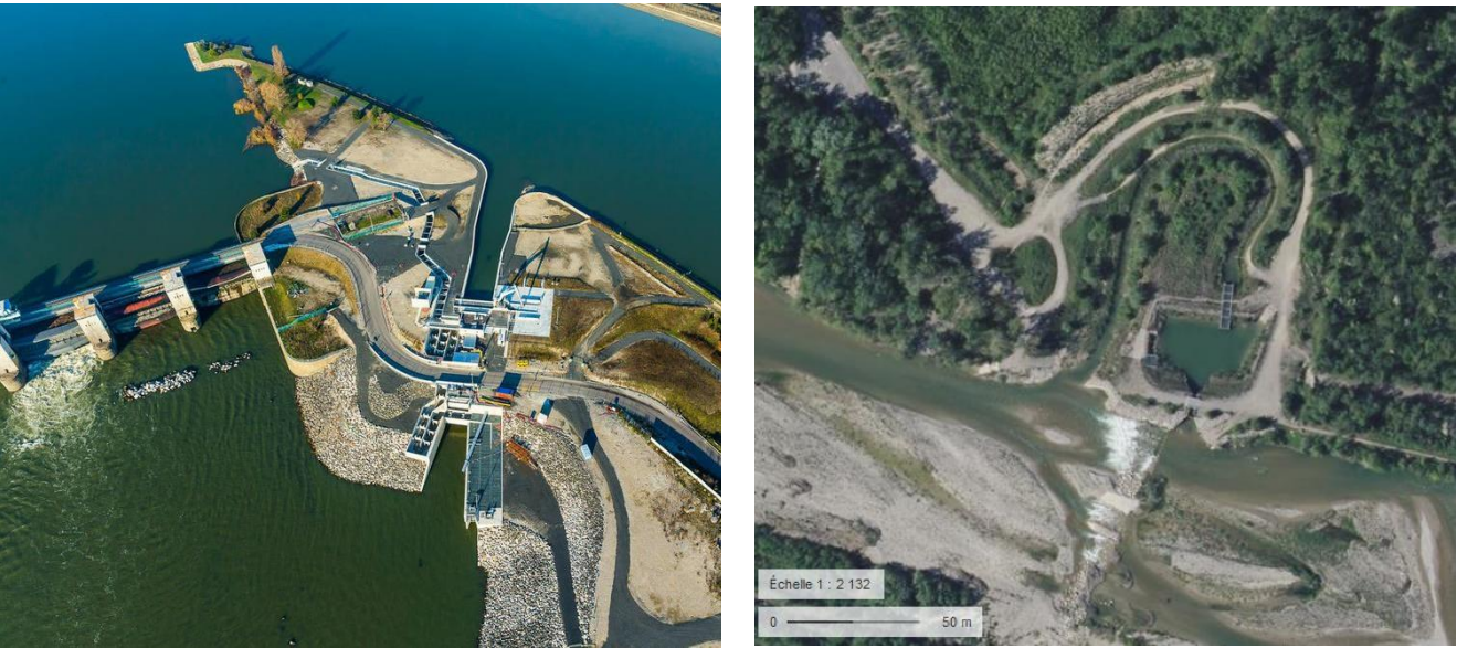
PCH et passes à poissons pour le franchissement du barrage du Pouzin (CNR, communication CFBR, 2017) et rivière de contournement du seuil du piège à gravier sur la Drôme (Géoportail, 2017, IGN)
