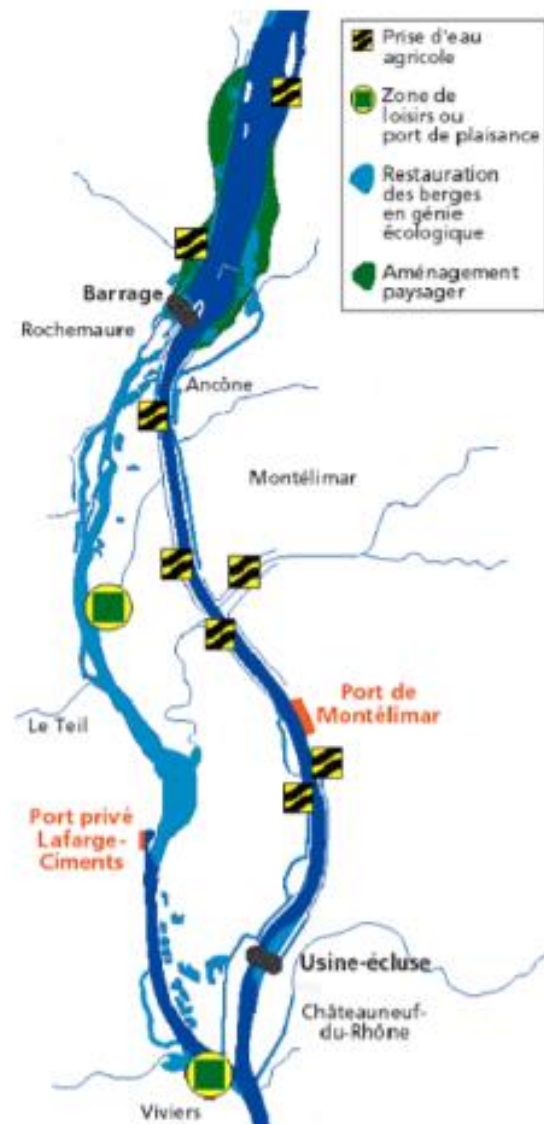
Figure 18.14 – Schéma de l'aménagement de Montélimar.
