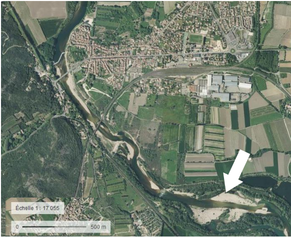
Le Gardon au droit de Remoulins, avec la gravière interceptée et en cours de comblement (Géoportail, 2018)
