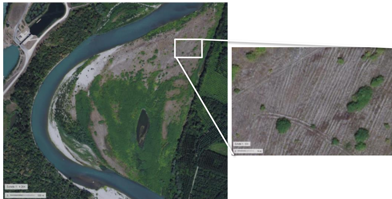
Banc charnué et essarté dans le RCC de Chautagne (UHC#05-CHA). Les zones de charriage correspondent aux secteurs sans végétation
