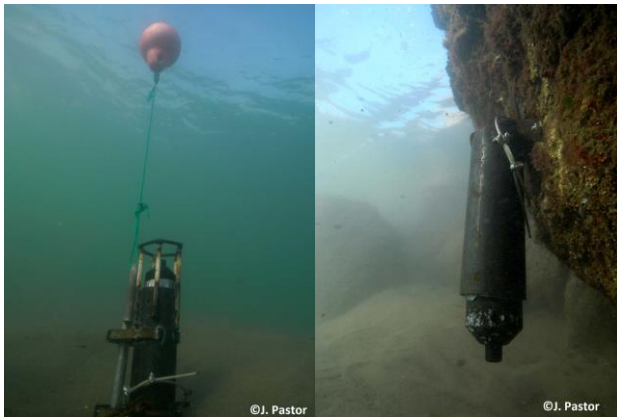
Figure 16. Systèmes de fixation des récepteurs par vis à sable (photo de gauche) et par fixation dans la roche (photo de droite).
