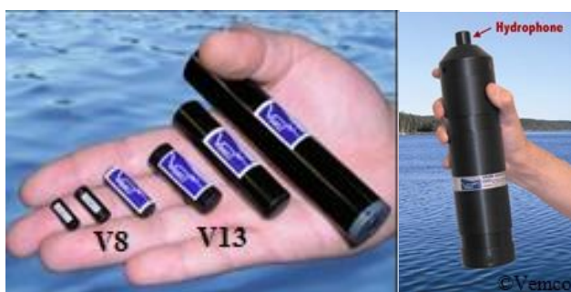
Figure 14. Marques acoustiques V8 et V13 et récepteur (ou hydrophone) VR2W de VEMCO utilisés lors du projet.
