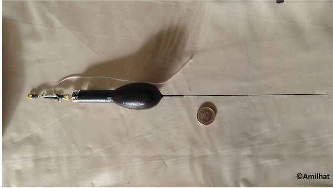
**Figure 11.** Balise satellite de type X-tag PSAT fabriqué par Microwave Telemetry (Columbia, USA).
