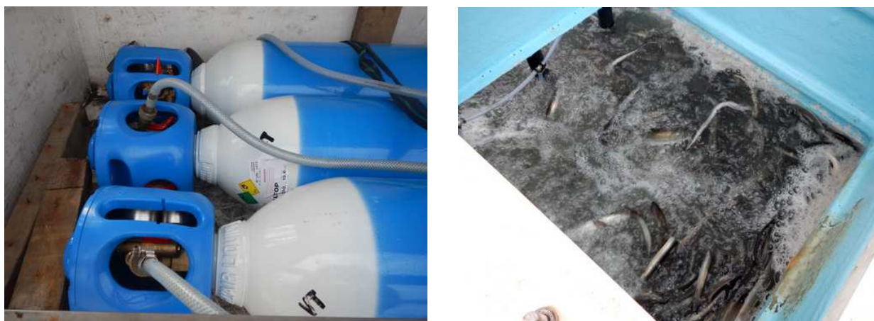
Figure 4 : Système d'aération (pompes à air) et d'injection d'oxygène pur (bouteilles d'oxygène comprimé).
