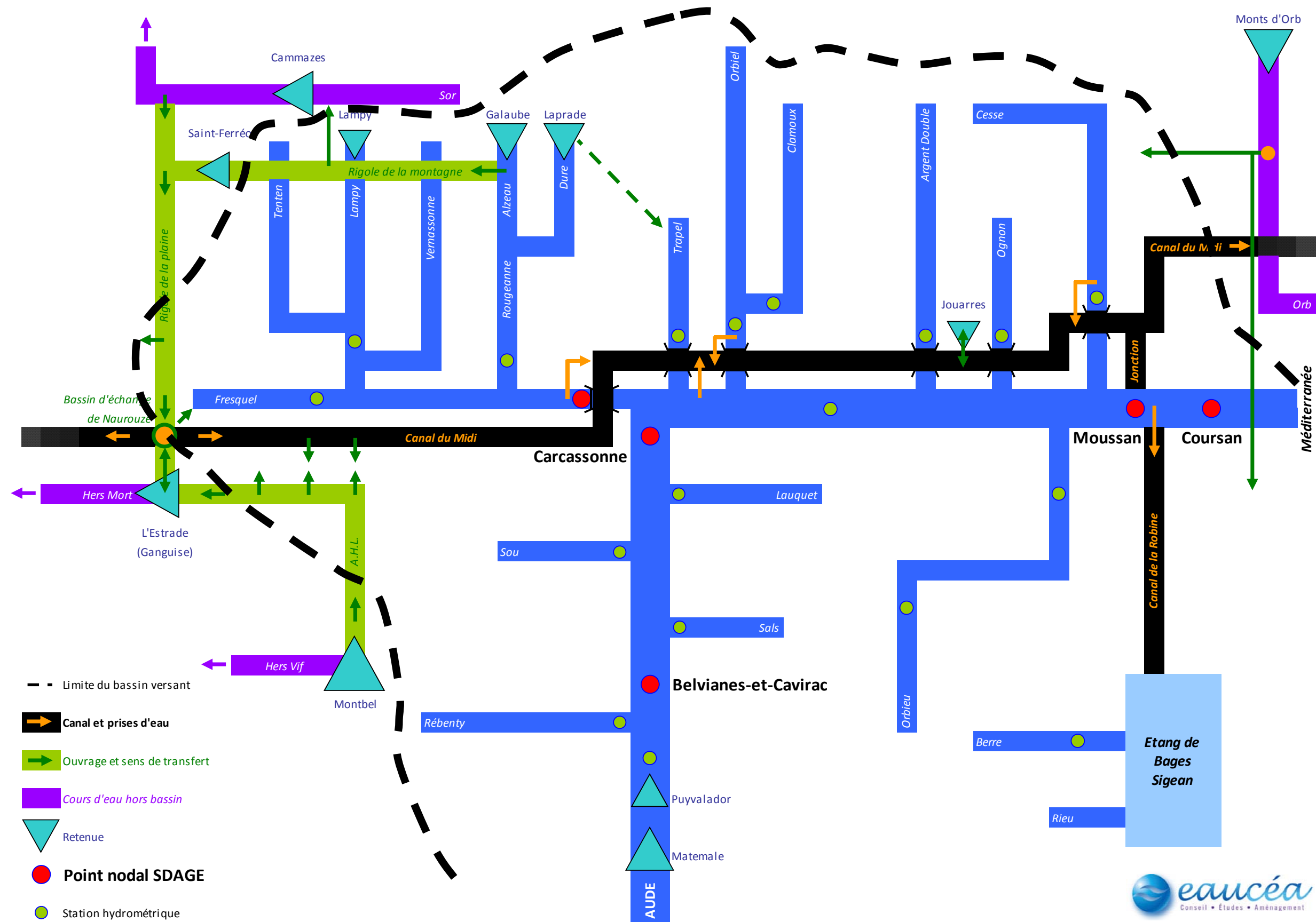
Figure 10: Schéma hydraulique du bassin versant de l'Aude
