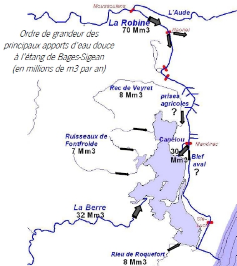
Figure 9 : extrait de l'étude hydrologique de l'étang de Bages Sigean : PNR de la Narbonnaise/Ifremer (mai 2012)
