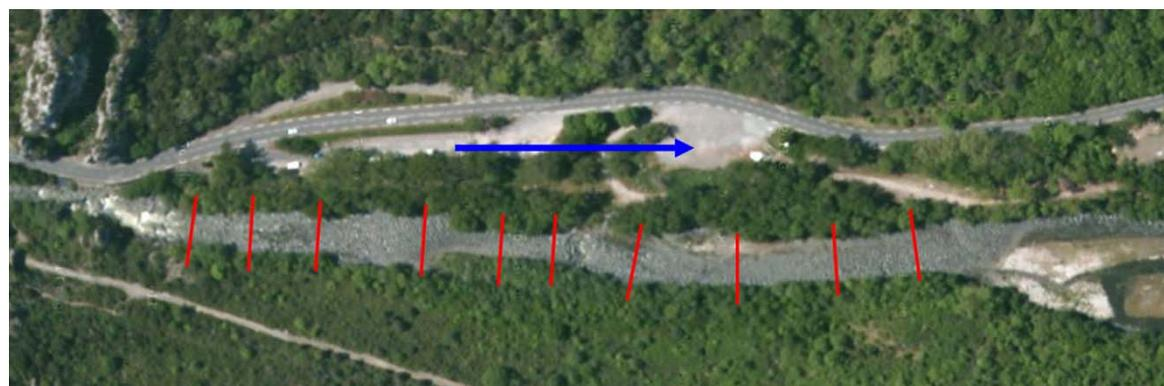
Les moyens mis en œuvre pour réaliser la mesure sont une mire et un appareil de localisation GPS afin de réaliser une topographie de la station, un profileur de courant à effet doppler acoustique (noté ADCP dans la suite) et un courantomètre afin de relever les vitesses et hauteurs d'eau dans le logiciel EVHA pour chaque section en travers.
