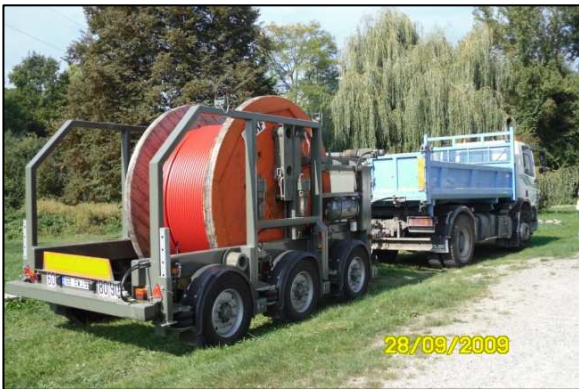
Touret / dérouleuse pour câble-antenne
