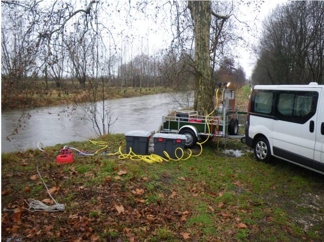
Prélèvements réalisés par centrifugeuse mobile sur les crues de l'automne 2012 :
