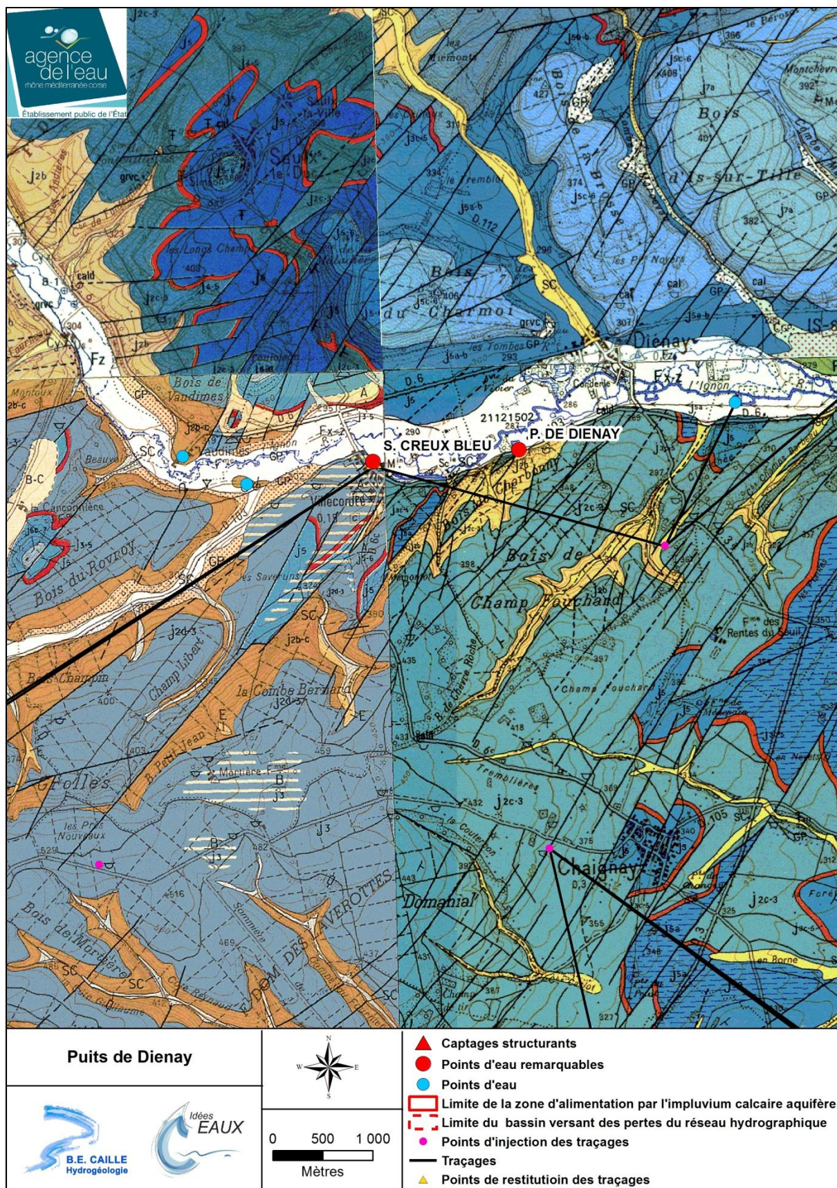
Figure 114 : Limite du bassin d'alimentation du puits de Dienay sur carte géologique au 1/50 000 ème
