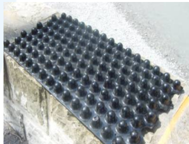
Plastique ABS thermoformé « fish-Pass »
