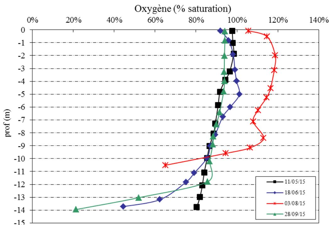
Figure 15 : Profils verticaux d'oxygène (% sat.) au point de plus grande profondeur
