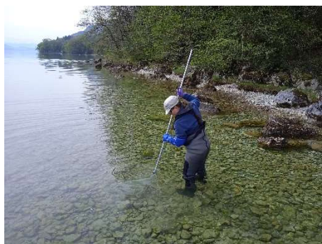
Figure 7 : Echantillonnage IML sur la zone littorale d'un plan d'eau
