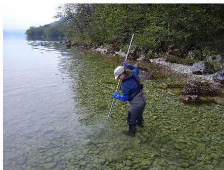
Figure 5 : Echantillonnage IML sur la zone littorale d'un plan d'eau
